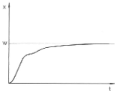
Abb. 65: Regelparameter T_n und T_v zu groß
